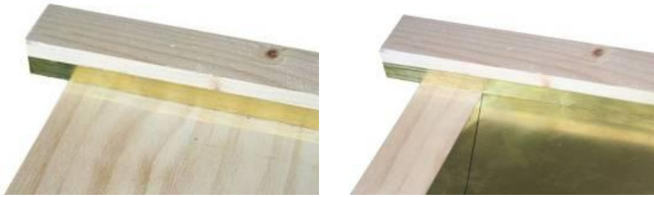
Fig. 31. Detalle de las canales y la colocación de los pliegos de metal en el mesolabio según Zarlino.
